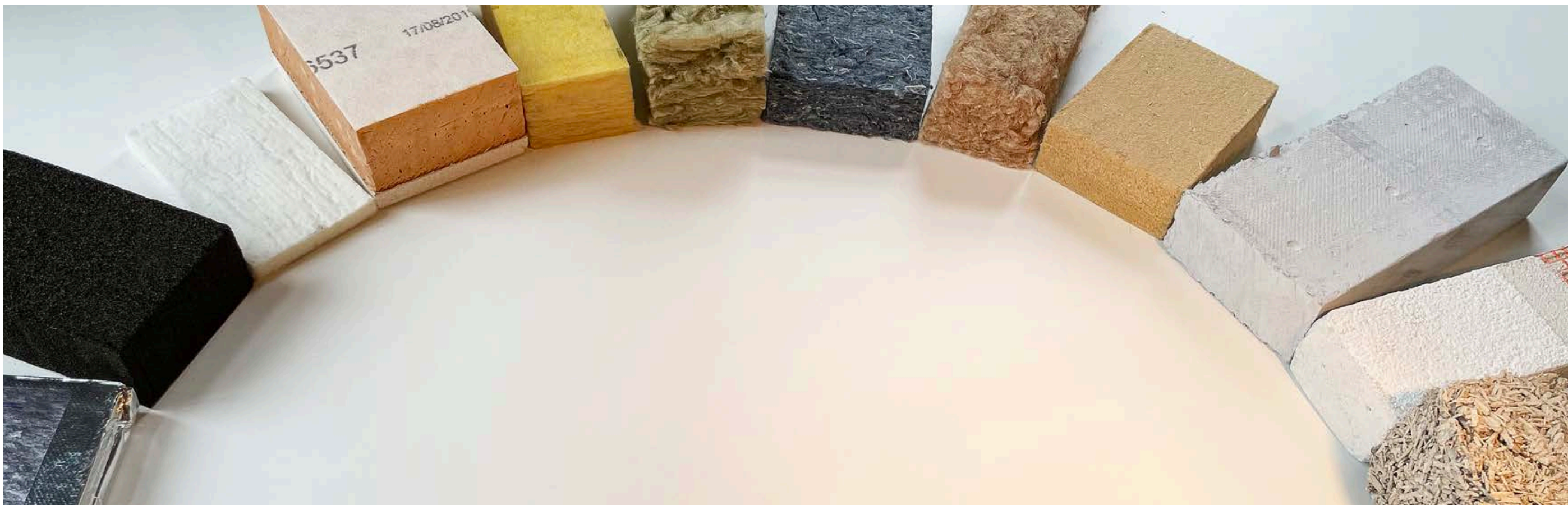
▲ Afbeelding XXIV De keuze van het juiste isolatiemateriaal is belangrijk. Er kunnen grote verschillen zijn in de eigenschappen van materialen, de wijze van verwerken, de milieu-impact en de prijs. We zien hier van links naar rechts: vacuümisolatie, schuimglas, een aerogeldecken, een resol hardschuimplaat, glaswol, steenwol, katoenisolatie (van gerecyclede spijkerbroeken), vlasisolatie, houtvezelisolatie, een stuk calciumsilicaatplaat, perlietstuc en een blok kalkhennep.
