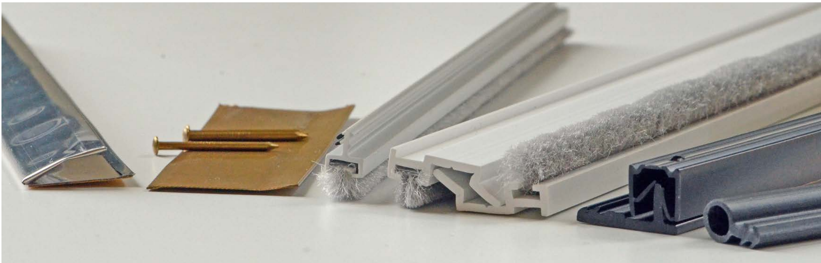
▲ Afbeelding XXIII Voor historische ramen zijn vele soorten kierdichting in de handel. We zien hier enkele voorbeelden. Van links naar rechts gaat het om een rvs-kierdichting (detailblad 4.13), bronzen kierdichting (4.17), borstelprofiel en wisseldorpeldichting (4.11), VR-strip en O-profiel (4.14).
